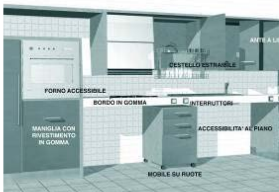
Fig.10.5 Lay-out ipotetica cucina accessibile
